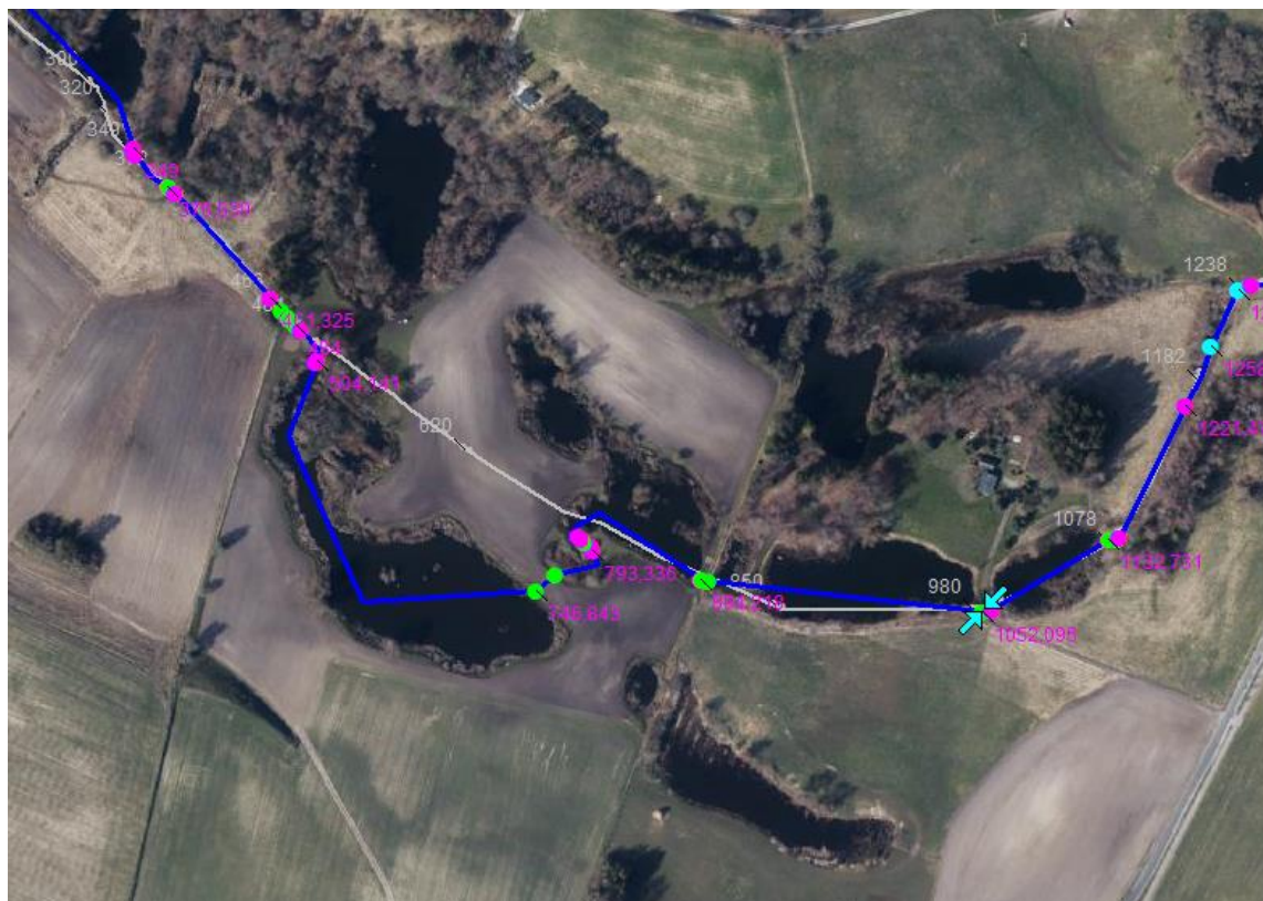
Figur 11 Vindue fra stationering i VASP viser strækning med søer st. 505 – 1134, hvor opmåling afviger fra regulativ.
